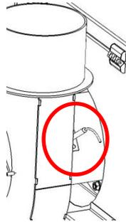
Die Befestigungsschraube lösen und den Fühler aus dem Rauchrohr ziehen. Anschließend mit einem Lappen von Ruß- und Schmutzpartikeln säubern.
