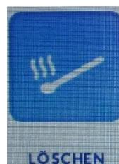
Um den Heizbetrieb des Pelletbrenners zu stoppen, tippen Sie auf „Menü“, „Löschen“ und bestätigen Löschen mit „JA“.
