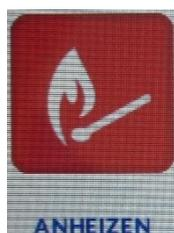
Um den Heizbetrieb mit dem ausgewählten Brennstoff zu starten, tippen Sie auf „Menü“, „Anheizen“ und bestätigen das Anheizen mit „JA“. das
